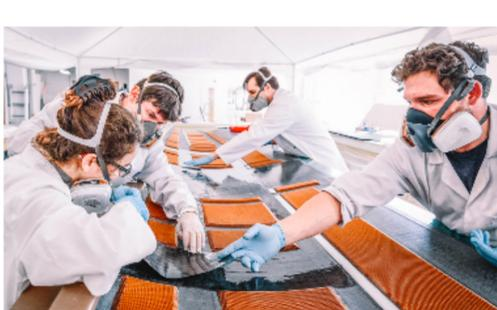
Struktur aus Verbundwerkstoffen: Die Tragflächenkomponenten bestehen stellenweise aus bis zu 60 Schichten.
