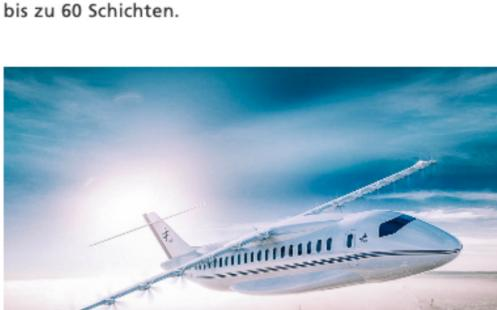
Das Konzept der Distributed Electric Propulsion (DEP) sieht mehrere auf den Flügeln verteilte Antriebe vor.
