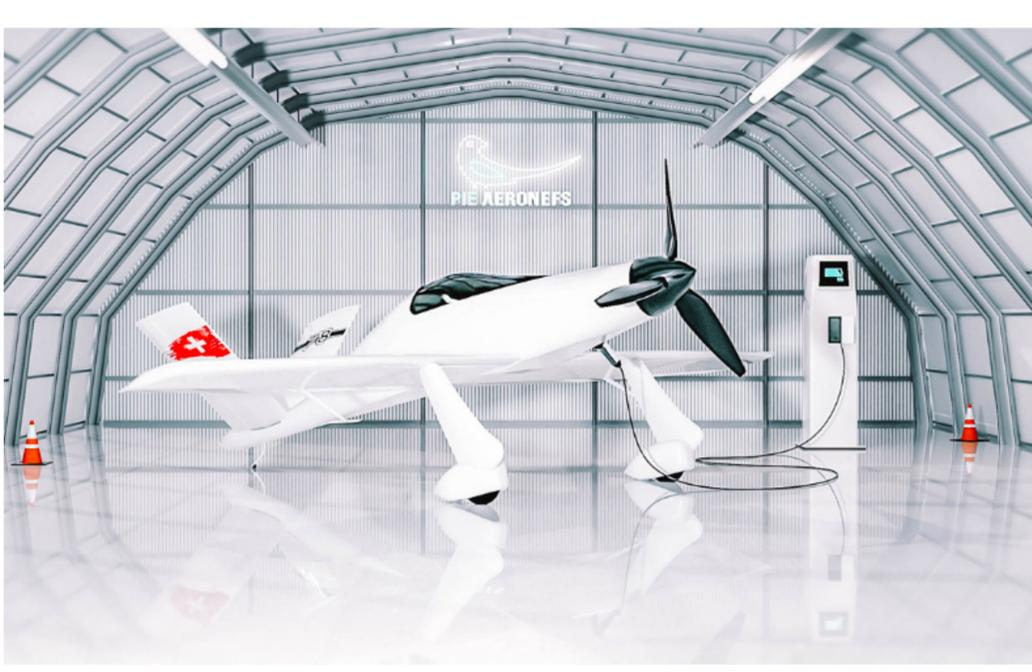
Im Kleinhangar aufladen: UR-1, das erste Schweizer E-Rennflugzeug mit 4,7 Meter Länge, verfügt über ein festes Fahrwerk und ein V-Leitwerk.
